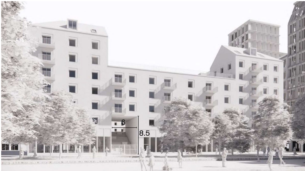
Figur 75. Illustration på hur man kan utforma portiker i markplan för att släppa ut skyfallsvatten från en upphöjd gård. Bild: White Arkitekter
