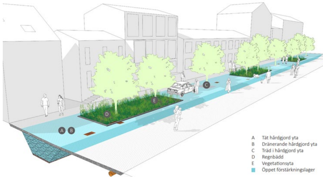
Figur 65. Exempel på gaturum med BGG-system förlagd i flexzon. Det blå området symboliserar ett öppet förstärkningslager som här ligger i ett stråk utmed hela gatan. På markytan varvas hårdgjorda ytor med regnbäddar, vegetationsytor och träd på valfritt sätt. På detta sätt ges stora möjligheter till hantering av dagvatten samtidigt som gaturummet kan utformas flexibelt. (Källa: Levande stadsrum –en handbok i Blågröngrå system, Edge 2024).
